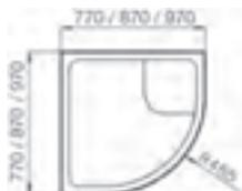
Высота каркаса из стиропора **без** душевого поддона: 170 мм
